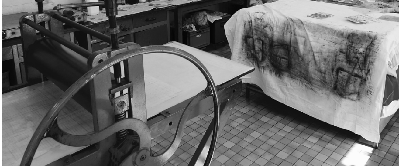
↑ Press a Botzstatioun wou déi iwwerschësseg Faarf ofgewëscht gi fir dann ze drécken
