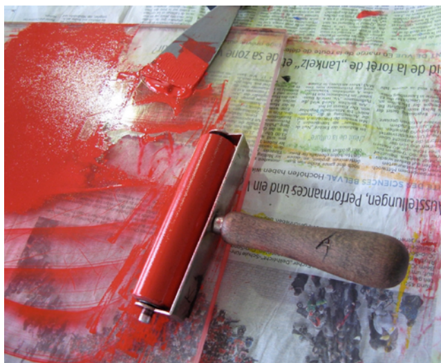
↑ Rullo fir d'Encréieren vu Lino an Holzplacken
