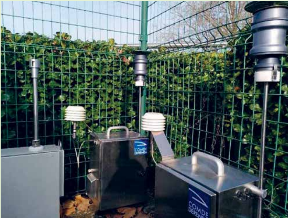
Installation des appareils de mesure de la station de mesure à la place de la Mairie : deux échantillonneurs à faible volume (PM10) de la société Comde-Derenda (à droite) et un compteur optique de particules (GRIMM EDM 264) (à gauche). Aufbau der Messgeräte am Messstandort Place de la Mairie: zwei Low Volume Sampler (PM10) der Firma Comde-Derenda (rechts) und ein optischer Partikelzähler (GRIMM EDM 264) (links).
