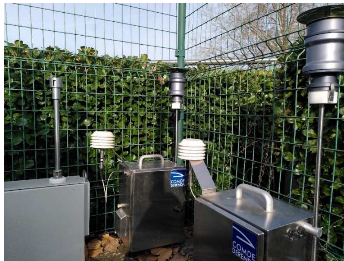
Abbildung 2: Aufbau der Messgeräte am Messstandort Place de la Mairie: zwei Low Volume Sampler (PM10) der Firma ComdeDerenda (rechts) und ein optischer Partikelzähler (GRIMM EDM 264) (links).
