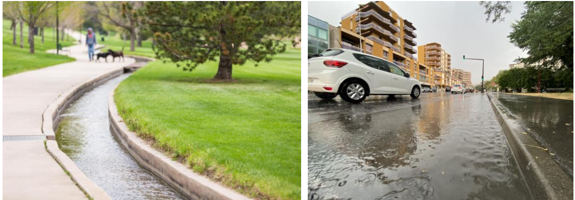
Figure 19: Exemple de mesures constructives (fossé urbain et bordures hautes)
