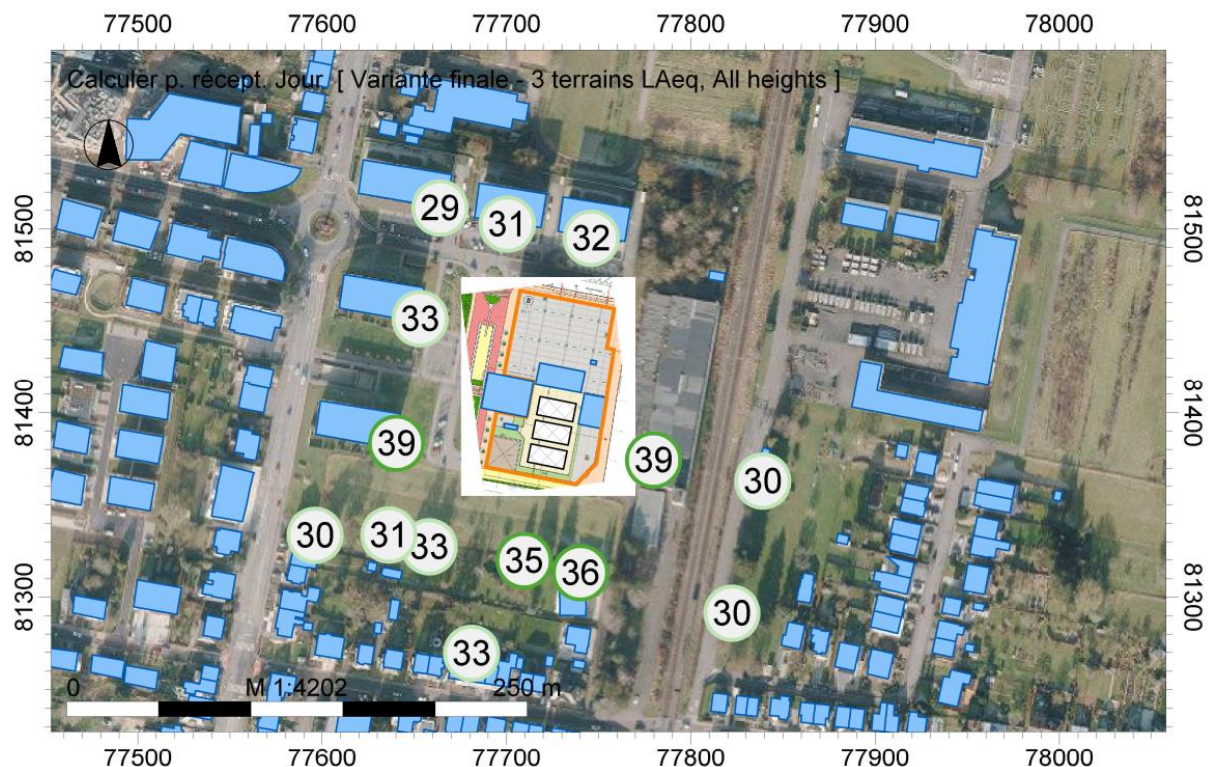
FIGURE 10: NIVEAUX DE BRUIT MOYENS L_{Aeq} AUX POINTS RECEPTEURS - SANS ECRAN ACOUSTIQUE
